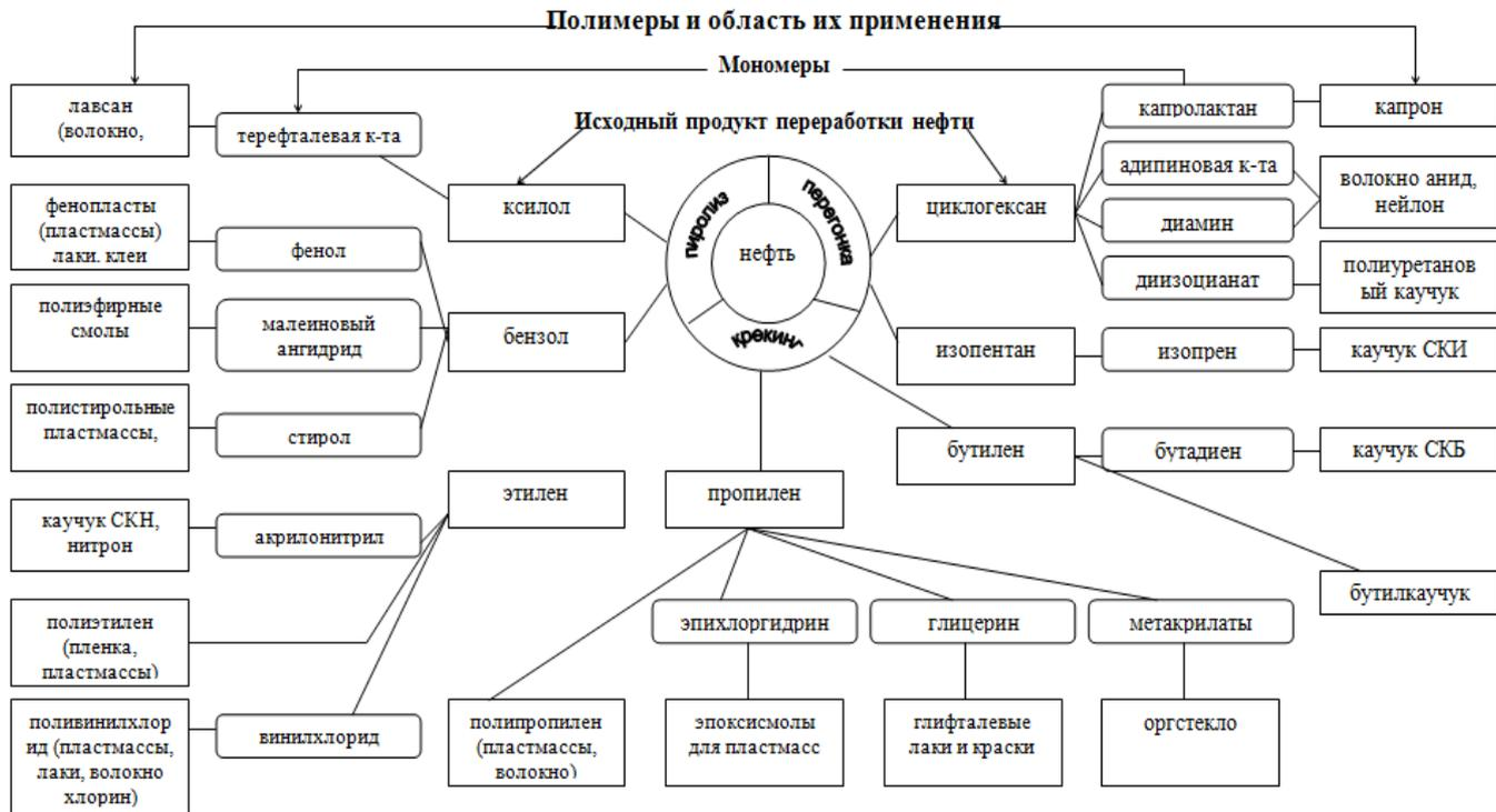
Рис. 10. Схема переработки нефти в полимеры
