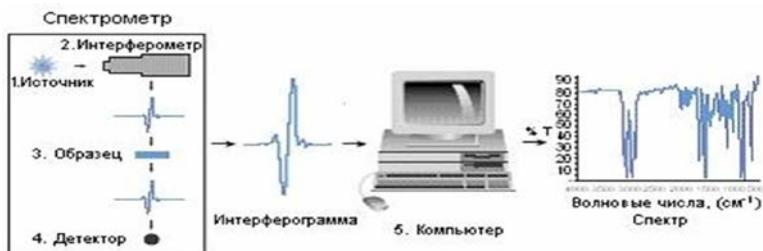
Рис. 2.2. ИК-спектроскопия с Фурье-преобразованием
