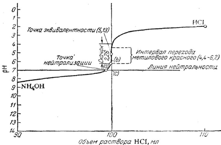
Рис. 2.3. Кривая титрования гидроксида аммония раствором HCl
