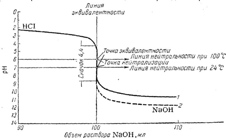
Рис. 2.1. Кривая титрования соляной кислоты ( $V_{\text{к-ты}} = 100$  мл) щелочью: 1 – при 100°C; 2 – при 24°C
