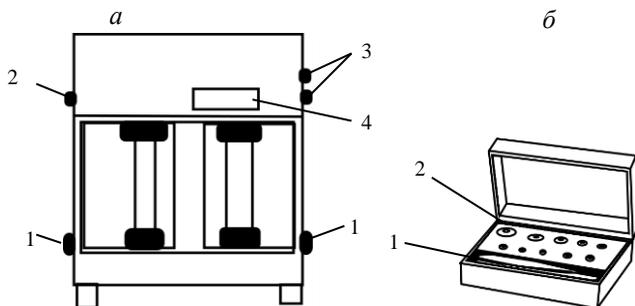
Рис. 6.7. Общий вид аналитических весов модели ВЛР-200 (а):
