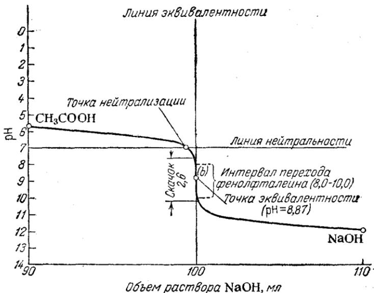
Рис. 2.2. Кривая титрования  $\text{CH}_3\text{COOH}$  раствором  $\text{NaOH}$
