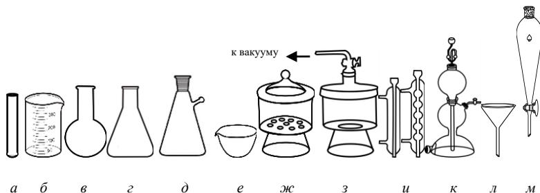
Рис. 6.1 Стеклянная посуда общего назначения: а – пробирка; б – химический стакан; в – колба круглодонная; г – колба коническая Эрленмейера; д – колба Бунзена; е – чаша выпаривательная с носиком; ж, з – эксикаторы; и – холодильник; к – аппарат Киппа; л – стеклянная воронка; м – делительная воронка
